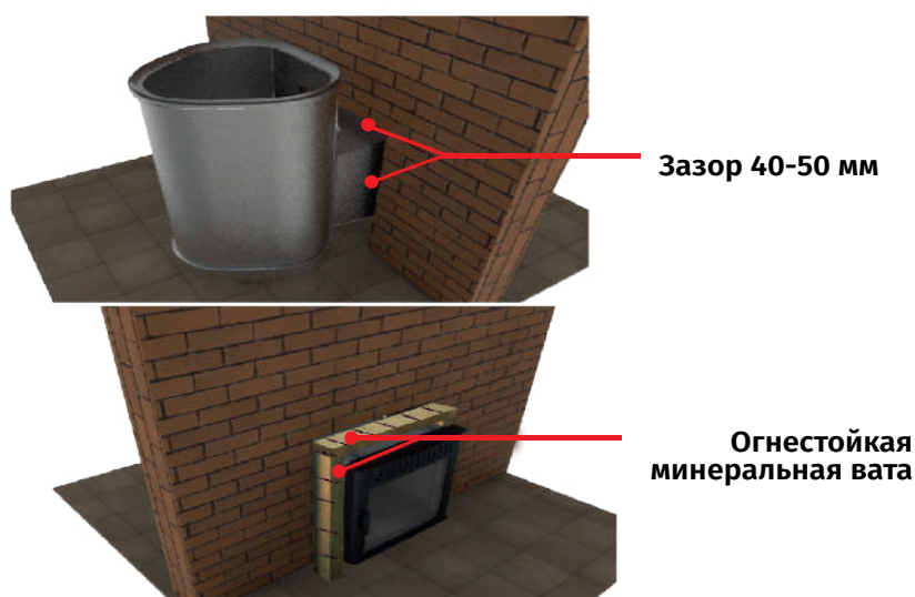
Рис.№ 5 Установка печи «Сквозь стену»
